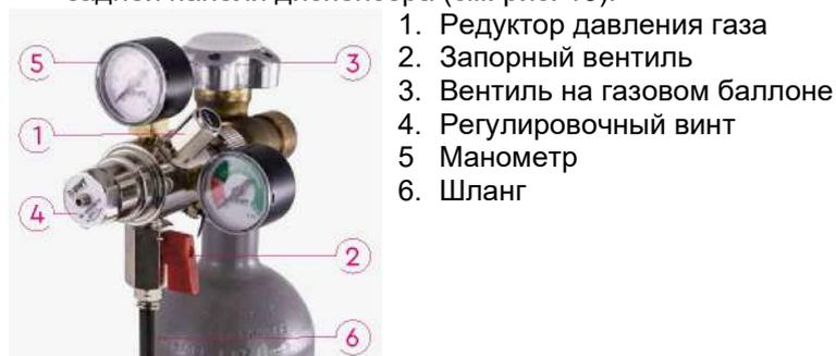
Рис. 9. Подключение баллона со сжатым CO<sub>2</sub>
