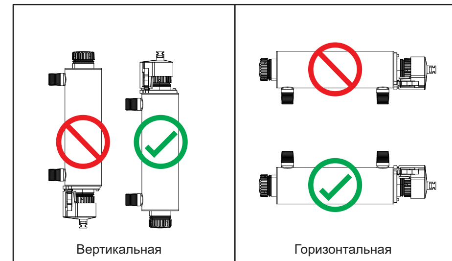
Рисунок 2 Установка системы дезинфекции — вертикальное и горизонтальное положение
